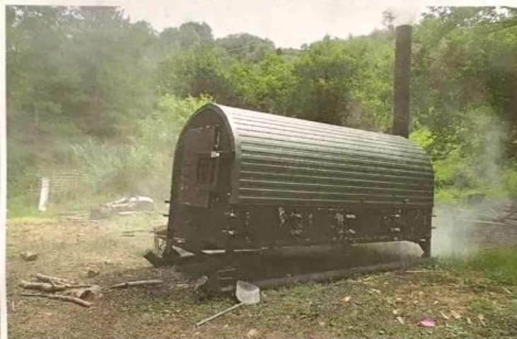
Il forno orizzontale con cui sull'Amiata si testa la produzione del carbone. In alto, l'antico procedimento di produzione a cupola
